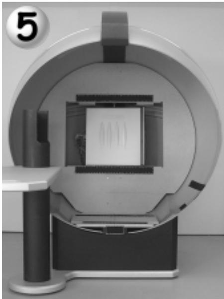
Sitzplatte und Rückwand einsetzen und mit Schraube **B**(12x) befestigen; PC einsetzen, verkabeln (siehe Verdrahtungsplan)
