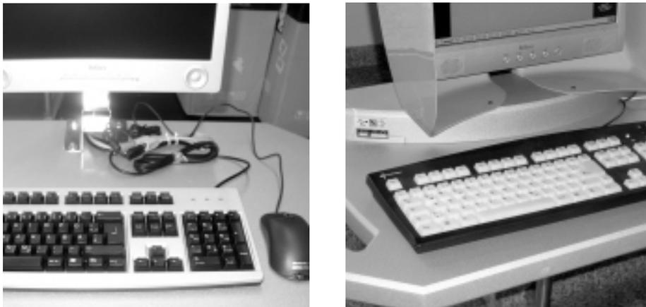
Tastatur, Maus und ggf. USB-Webcam anstecken, Restkabel bündeln. USB-/Audio-Anschlussplatine einlegen. Tischabdeckplatte Klappe mit Münzprüfer an Säulenrohr befestigen mit Mutter **D**(2x), aufsetzen, darauf achten, dass Tastatur-, Maus- und Kamerakabel nicht gequetscht werden und genügend Bewegungsfreiheit gegeben ist. Abdeckplatte von unten befestigen mit Schraube **F**(3x) und Unterlegscheibe **G**(3x)
