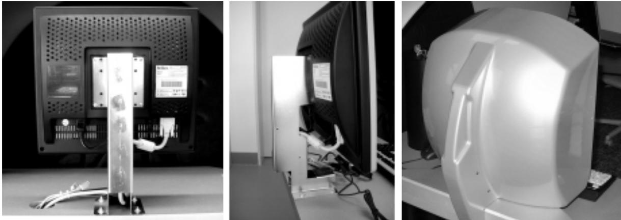
Monitor an Aufnahme befestigen mit Schraube **E**(4x) und Kabel(3x) anstecken
