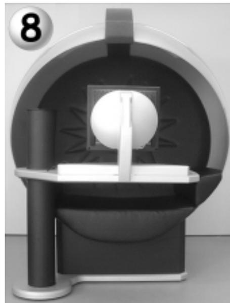
Monitor befestigen mit Schraube **E**(4x), anschließen und Abdeckung mit Schraube **E**(4x) befestigen; Tastatur/Maus anschließen, Tischabdeckung mit Schraube **F**(3x) und Scheibe **G**(3x) (siehe nächste Seite)
