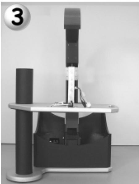
Tischplatte mit Schrauben **A**(7x) befestigen, Kabelbaum einlegen
